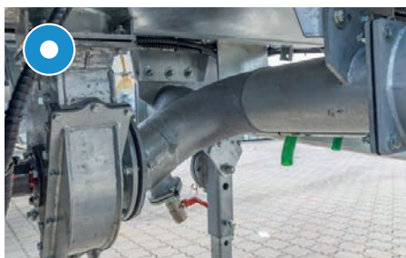
Hidraulikus turbótöltő a tartály alatt középen
