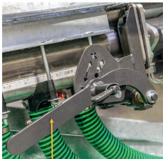
A karon a lyuk mérete mechanikusan beállítható.
