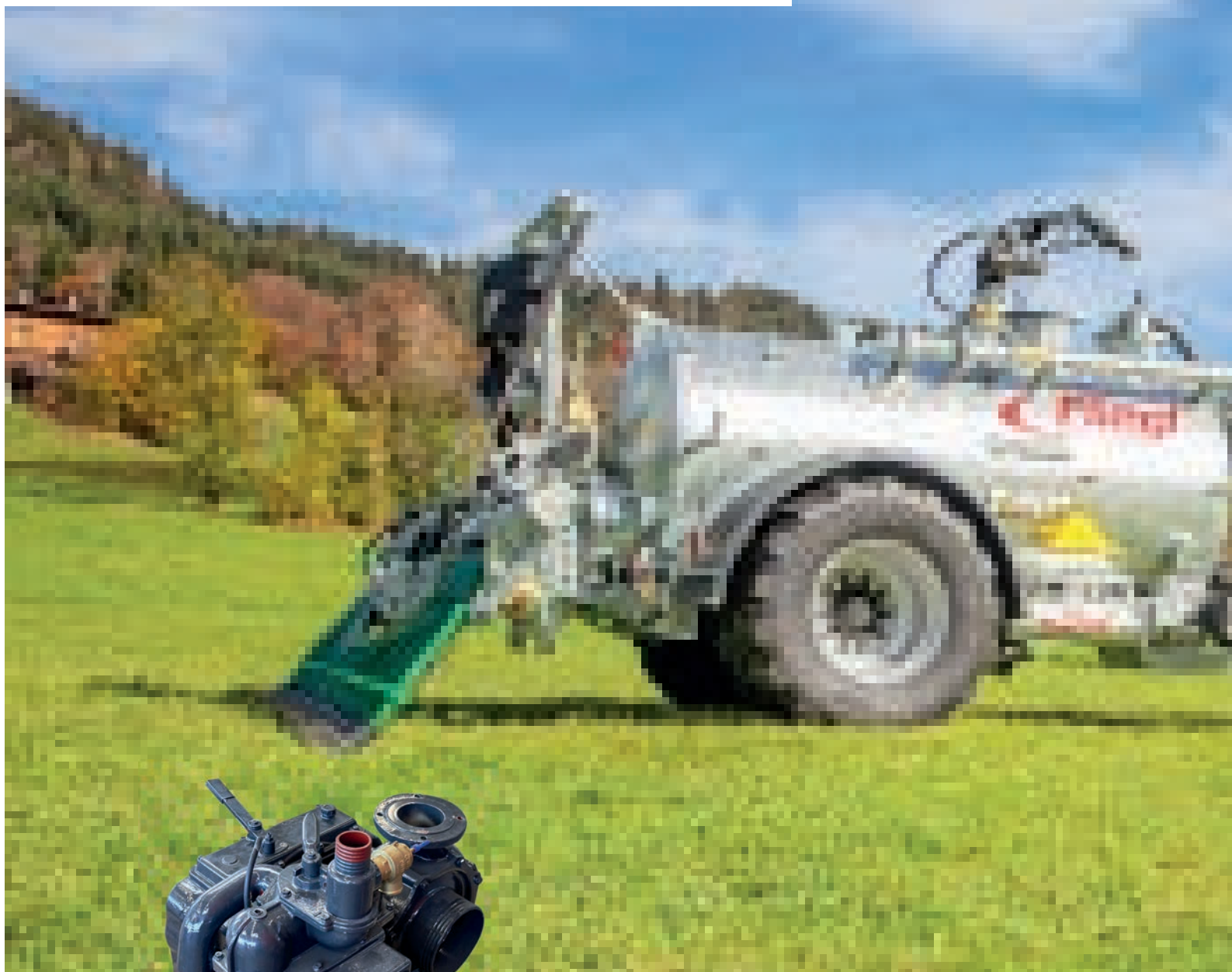
GARDA-Pumpa: A centrifugálszivattyú és kompresszor kombinációja
