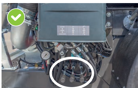
Vezérlés külső működtetéssel (csak forgódugattyús szivattyúval együtt)
