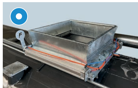
Pneumatikus tolótető a felső töltéshez
