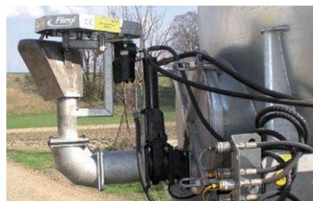
Hidraulikus csóváló terítő 12-18 méteres munkaszélességgel
