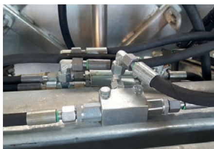
Nyomásszabályozó szelep
