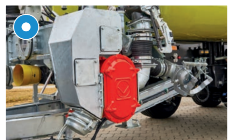
Rendkívül könnyen karbantartható: mechanikus meghajtású forgódugattyús szivattyú reduktorról
