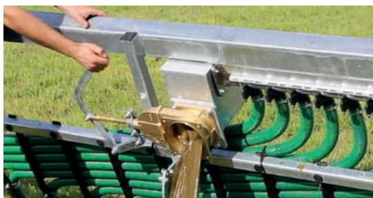
Kő- és idegentestgyűjtő mechanikus vagy hidraulikus úrtéssel
