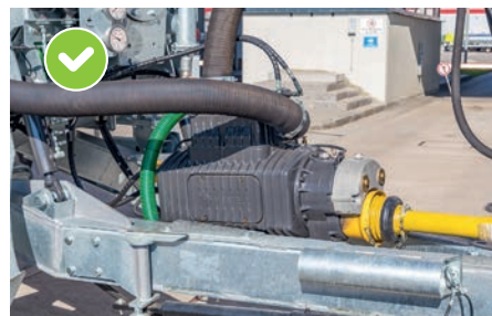
Hőálló kompresszor Opció: vízhűtéses kompresszor
