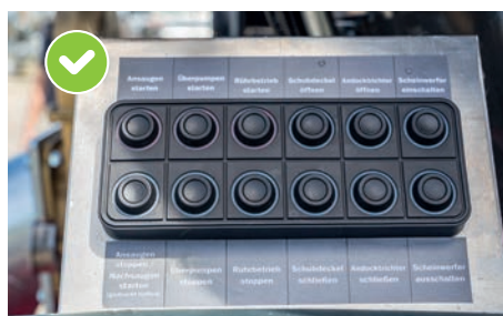
Vezérlés külső működtetéssel (csak forgódugattyús szivattyúval együtt)
