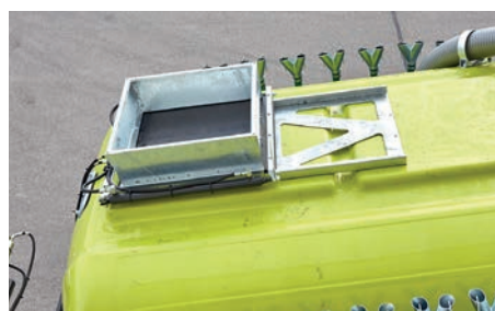
Pneumatikus vagy hidraulikus tolótető (600 x 600 mm)
