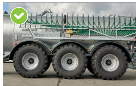
Egyedi kerékkivágás a hidraulikus rugózással kapcsolatban
