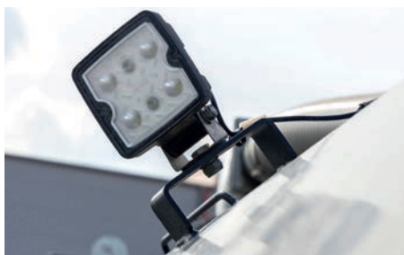
Munkalámpák a terítőegység megvilágításához
