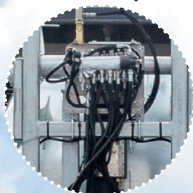
Vezérlőblokk olajsűrővel
