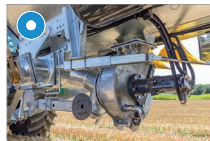
Vákuumos tartálykocsik esetén: turbótöltő a tartály alatt középen a mindkét oldali szíváshoz
